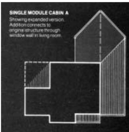
Modulo singolo edificio tipo A
