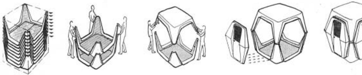
Fasi di assemblaggio delle scocche dell'unità
