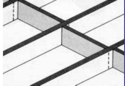
Solaio a travi principali e controventamenti in travi secondarie
